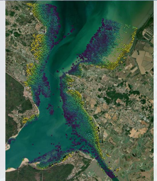
*Caractéristiques topographiques de zones intertidales : élévations Swot (élévations en couleur (points); jaune élevées; vert faibles) à marée basse (Réserve Naturelle de Moëze-Oléron) superposées à une image satellite optique.*
