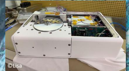
Container Marcus pour analyse  $\mu$ XRF en synchrotron (ID16B@ESRF)
