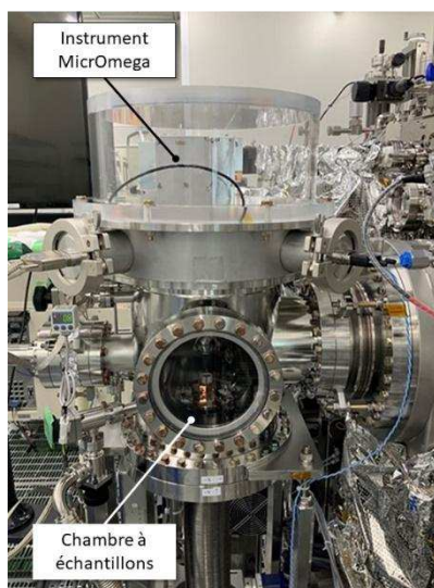
Fig. 2. L'instrument MicrOmega de Hayabusa 2 installé dans la salle de curation de la Jaxa
